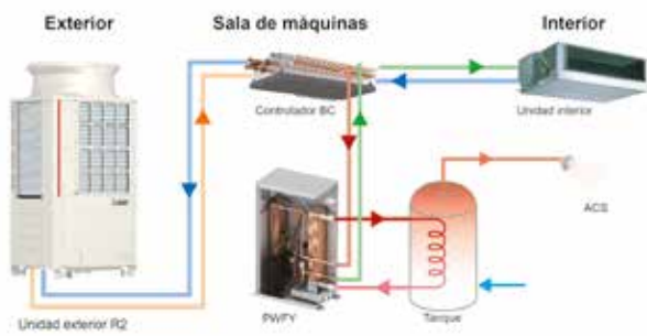
Diagrama PWFY-BU: ACS hasta 70°C con recuperación de calor
