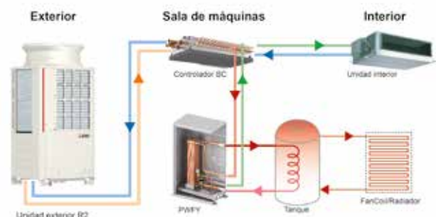
Diagrama PWFY-AU: Agua caliente hasta 45°C
